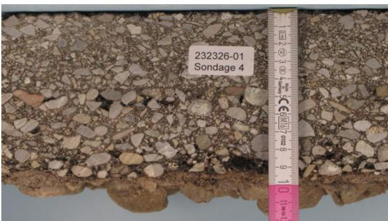
Belagsaufbau und Fundationsschicht
