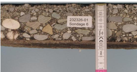
Belagsaufbau und Fundationsschicht
