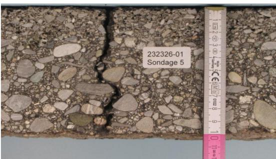
Belagsaufbau und Fundationsschicht
