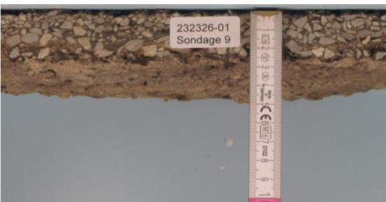
Belagsaufbau und Fundationsschicht
