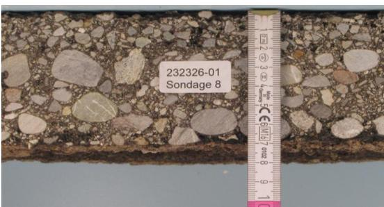
Belagsaufbau und Fundationsschicht
