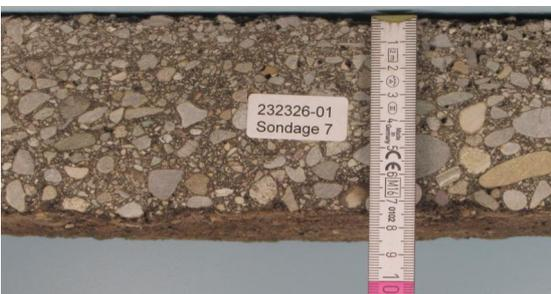
Belagsaufbau und Fundationsschicht
