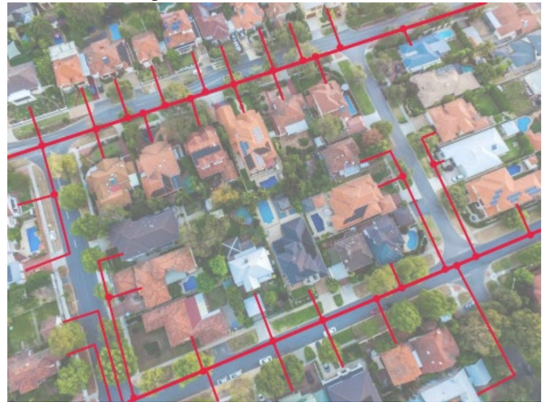
Erschliessung über Stammkabel und Muffen
